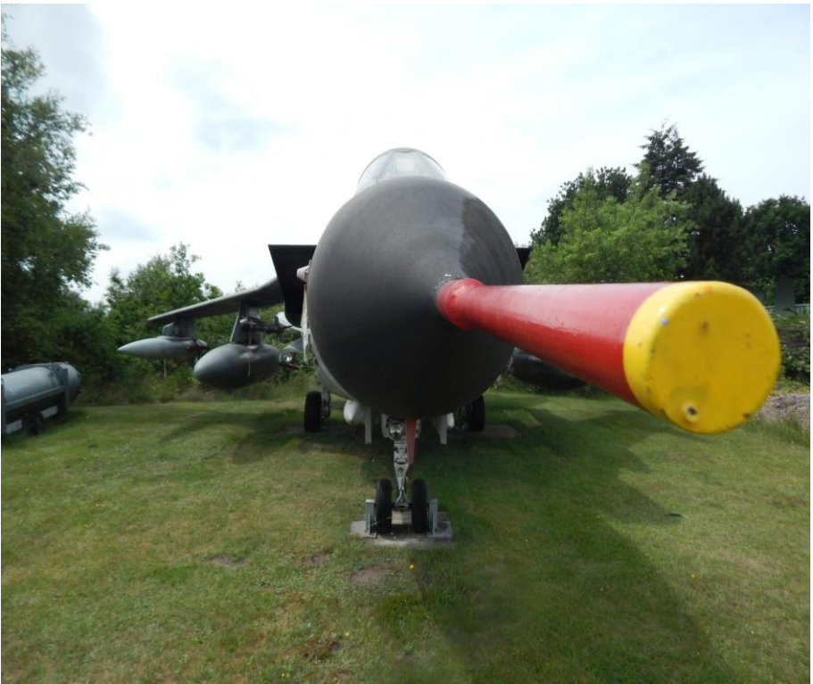
Tornado Panavia PA 200 ( Jagdbomber ) des Marinefliegergeschwaders Nordholz Startgewicht 27.990 Kg, Bombenlast 8165 kg, Geschwindigkeit 2130 km/h
